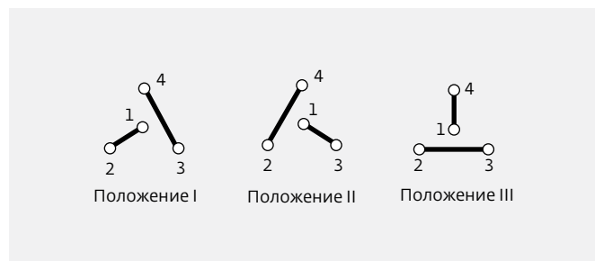
Рис.15. Возможные пути прохождения сигнала в T-переключателях
