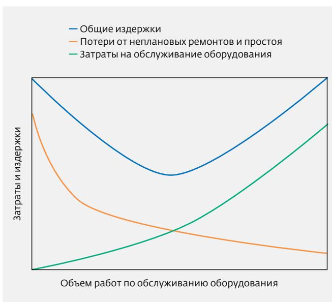
Рис.1. Зависимость затрат от объема работ по обслуживанию оборудования
