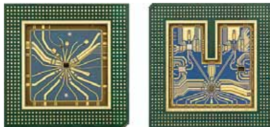
Многокристальные модули разработки Keysight, в состав которых входят InP-чипы
