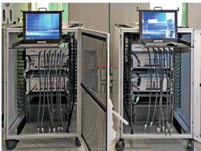
Рис.1. Многоканальный комплекс когерентного приема (слева) и генерации (справа) сигналов
