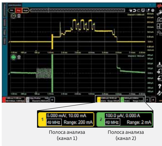
Рис.6. Отображение эффективной полосы анализа измерений в малых диалоговых окнах
