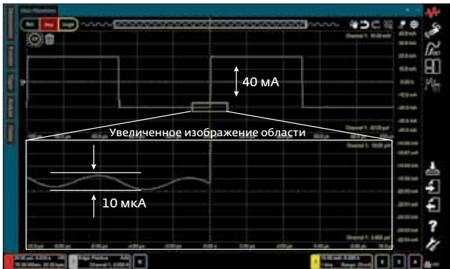
Рис.3. Пример измерения с широким динамическим диапазоном: одновременное измерение формы сигналов тока амплитудой 40 мА и 10 мкА
