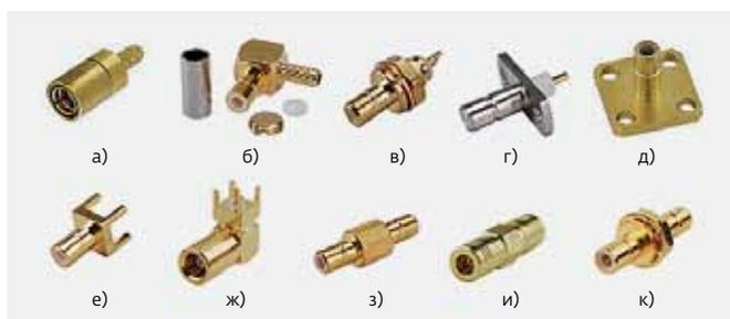
**Рис.4.** Соединители SMB: а – вилка кабельная прямая (обжим, гибкий кабель); б – вилка кабельная угловая (обжим, гибкий кабель); в – вилка кабельная прямая проходная; г – вывод энергии, розетка прямая панельная фланцевая; д – розетка прямая фланцевая; е – розетка прямая для установки в отверстия печатной платы; ж – розетка угловая для установки в отверстия печатной платы; з – адаптер SMB розетка-розетка; и – адаптер SMB розетка-вилка; к – адаптер SMB вилка-вилка
