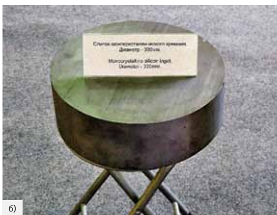
Рис.8. Зал с установками выращивания УВК-300 (а), монокристалл кремния диаметром 300 мм (предприятие "УКМ-Синтез") (б)
