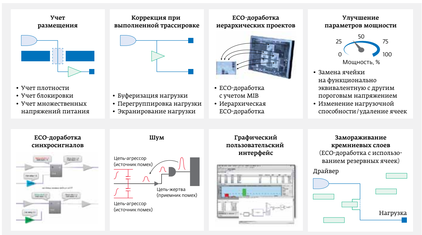
Рис. 7. ECO-функции инструмента PrimeTime
