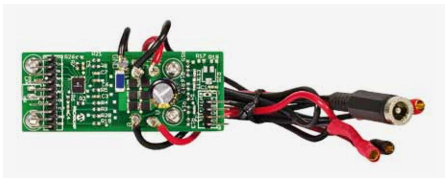
**Рис. 3.** Демонстрационная плата для 3-фазного 85-В драйвера MOSFET MIC4607 от Microchip
