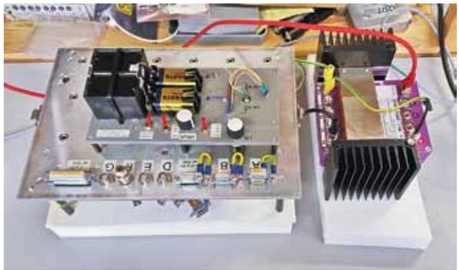
**Рис. 10.** Подключение тестового образца для исследования резисторов большого номинала
