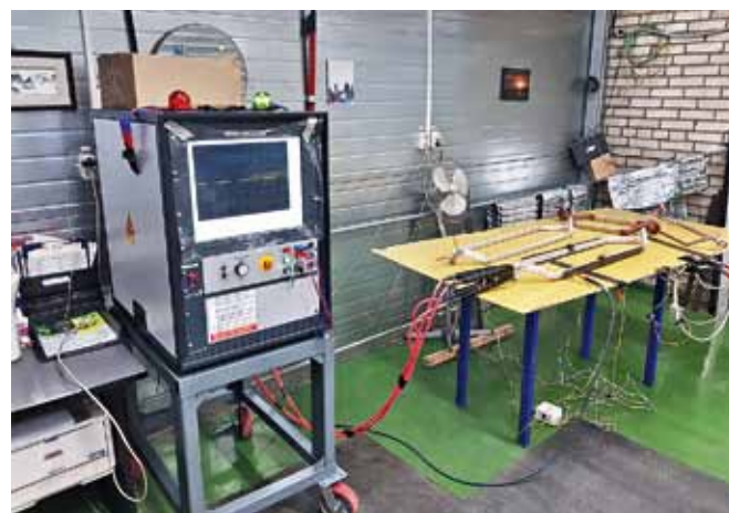
Рис. 2. Тестер МТС2 40KV и шаблонная катушка
