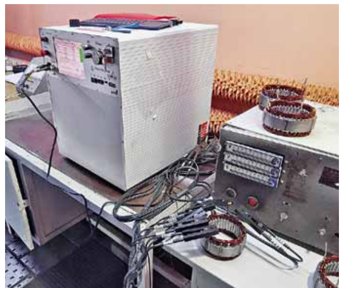
Рис. 4. МТС2 6KV с опцией тестирования прочности изоляции
