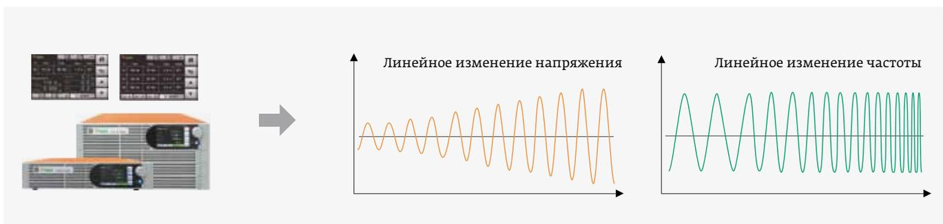
Рис. 5. Линейное изменение параметров сигнала
