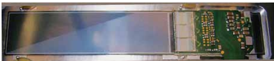
Рис. 1. Конструкция модуля кремниевого детектора эксперимента D0
