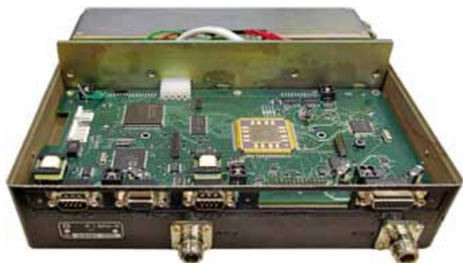
Рис. 4. Внешний вид блока радиостанции со снятой крышкой
