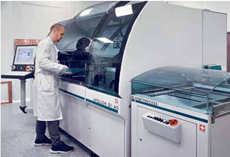
Установка прямого светодиодного экспонирования Apollon-D1-A11
