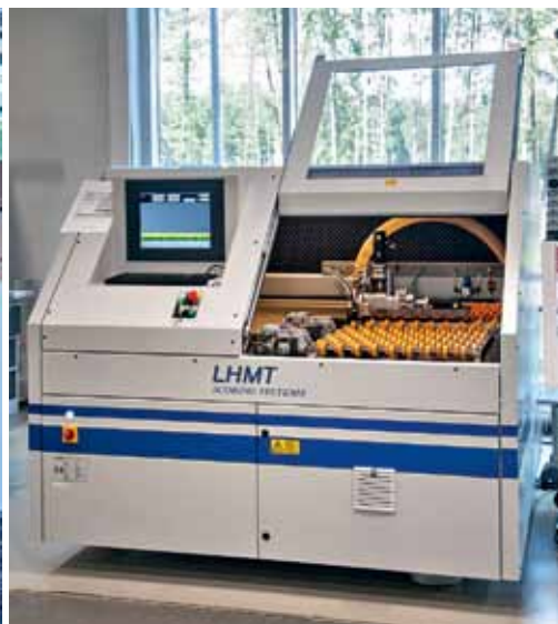
Механическое производство: слева – фрагмент панорамы участка сверления; справа – установка скрайбирования
