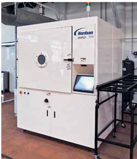
Автоматическая плазменная установка обработки поверхностей ProVia компании Nordson MARCH (США)
