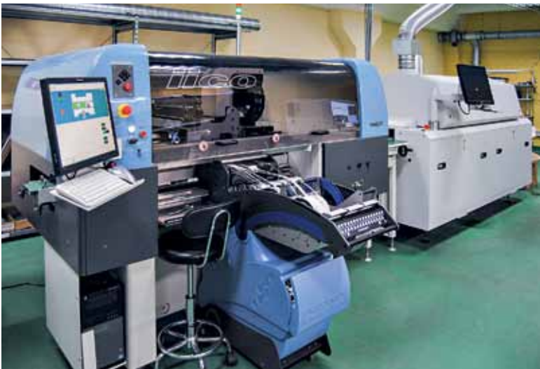
Автоматический установщик компонентов поверхностного монтажа Europlacer iico и конвекци- онная печь оплавления припоя SMT XXS
