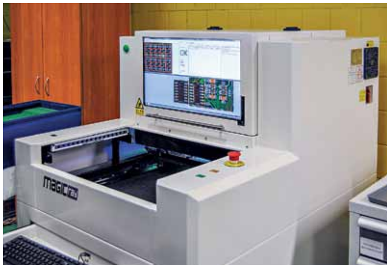
Установка автоматической оптической инспекции компании MagicRay
