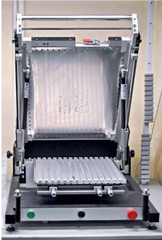
Ручной трафаретный принтер Mechatronic Systems S20
