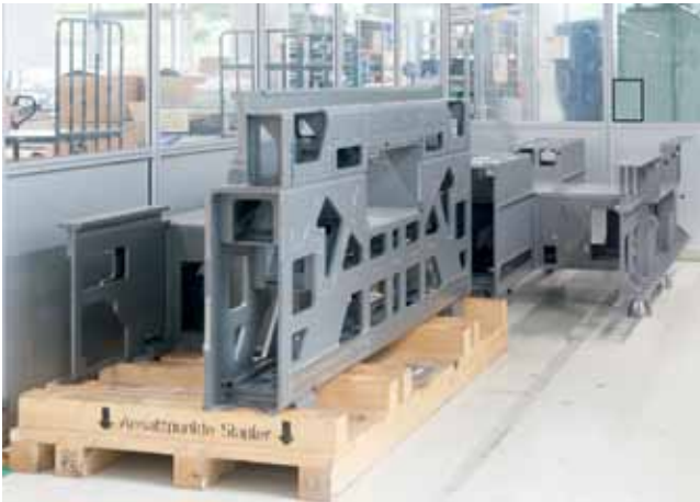
Рамы автоматов поверхностного монтажа (слева). Этап 2. Установка электрооборудо- вания (справа)
