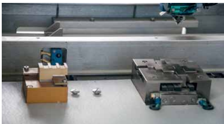
Магазин насадок (слева) и устройство механического центрирования (справа) автомата Siemens MS-72
