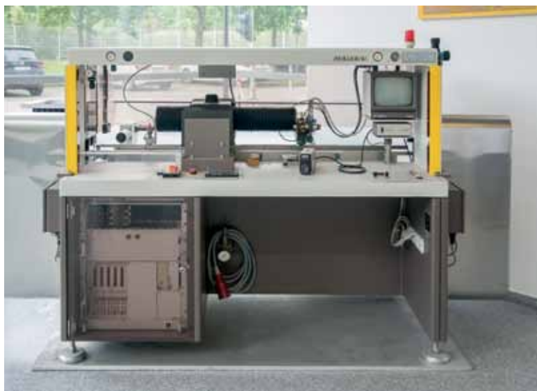
Первый автомат установки компонентов поверхностного монтажа Siemens MS-72
