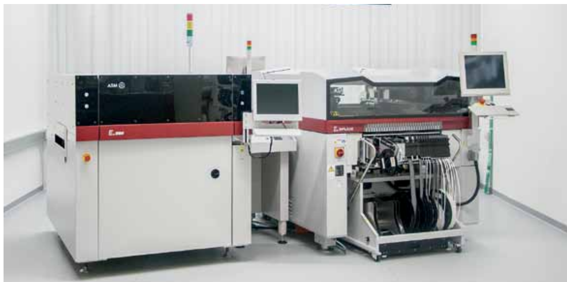
"Уголок Е". Установка трафаретной печати E by DEK (слева) и авто- мат установки компонентов E by SIPLACE (справа)
