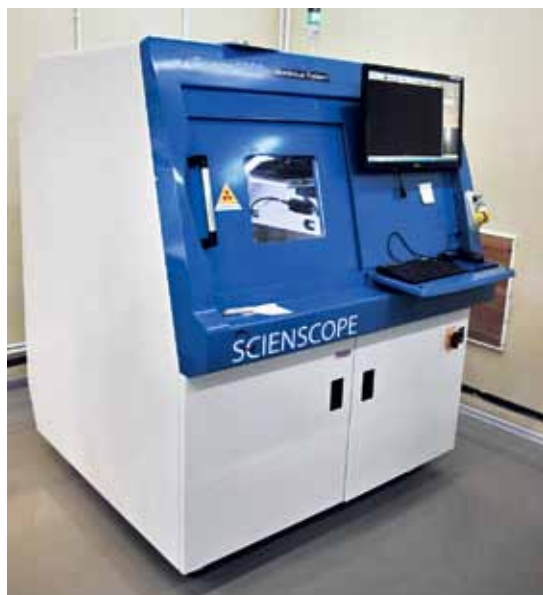
Установка рентгеновского контроля X-score 3000 фирмы Scienscope
