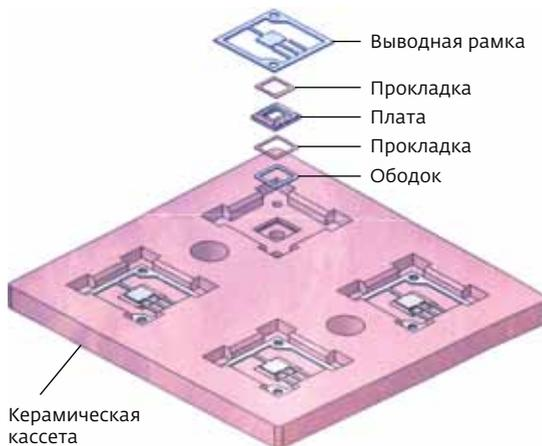
укладываются на керамические пластины, из которых при помощи керамических же вкладок составляется "этажерка".
