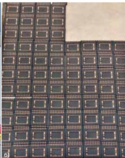
Разделение групповой заготовки: а – установка резки сырой керамики КЕКО CM-15; б – разделенные заготовки корпусов
