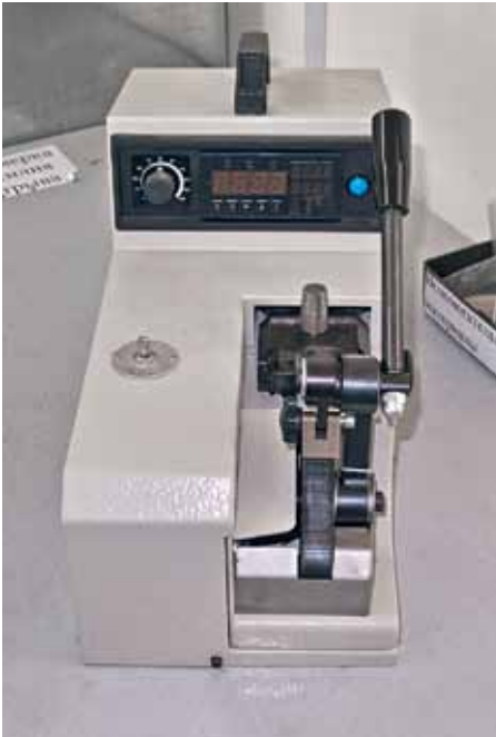
Установка для проверки усилия на отрыв Mecal SMST (слева). Стенд проверки геометрии жгута аккумуляторно-стартерной группы (справа)
