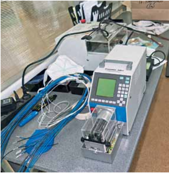
Полуавтомат Cosmic 48R компании Комах для зачистки тонких коаксиальных проводов (слева). Участок финишной сборки автомобильных жгутов (справа)
