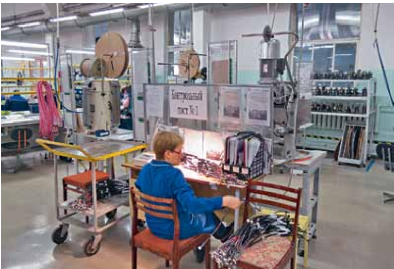
Контрольный пост №1 после предварительной сборки автомобильных жгутов
