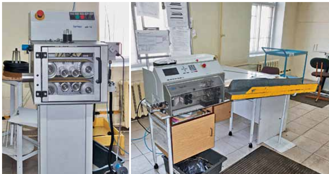
Участок жгутов аккумуляторно-стартерной группы. Размотчик кабеля Komaх ads 112 (слева), установка нарезки и зачистки Komaх Карра 235 (справа)
