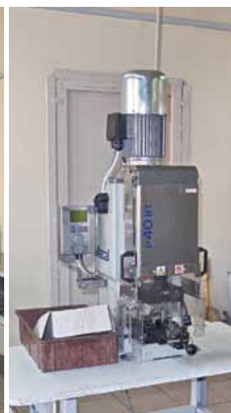
Прессы обжима наконечников компании Mecal – p200 BT (слева) и p40 BT (справа)
