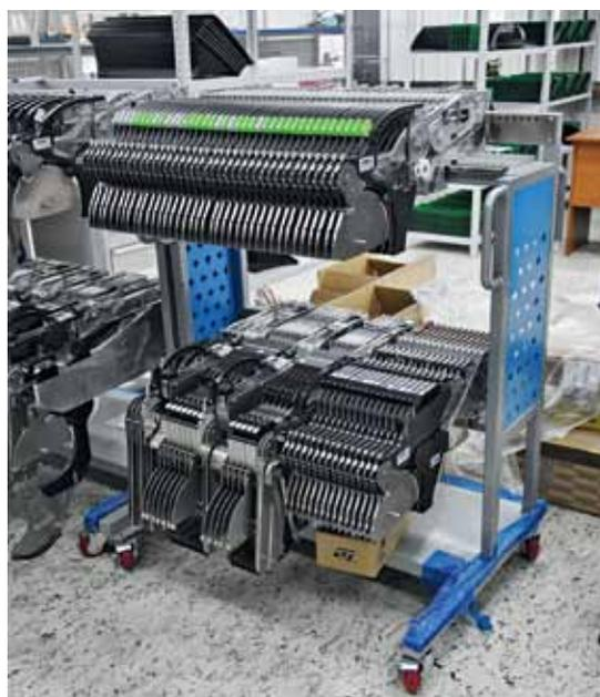
Второй станок – прецизионный установщик SM482 для работы с более крупной элементной базой: микросхемами, в том числе BGA, и с чип-компонентами больших типоразмеров. Может устанавливать практически все виды микросхем, достаточная точность, хорошая скорость, низкий уровень шума.
