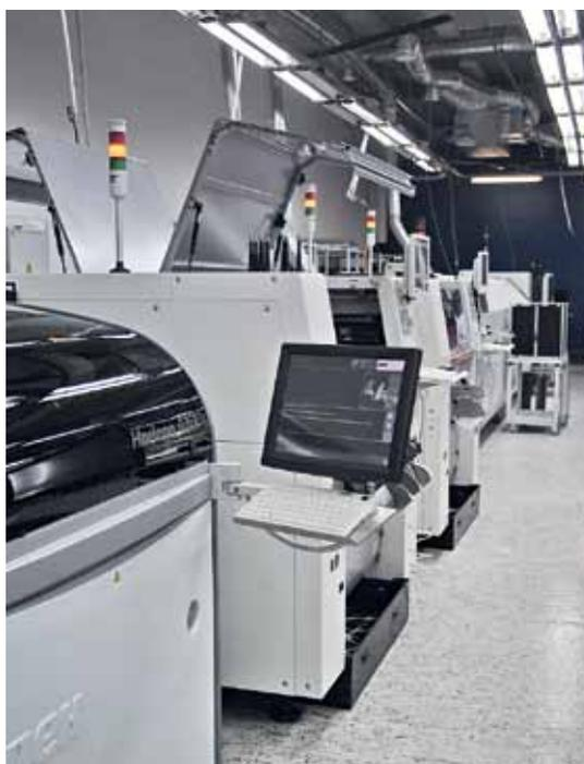
Новая автоматическая линия поверхностного монтажа в цехе компании "ПСБ технологии"
