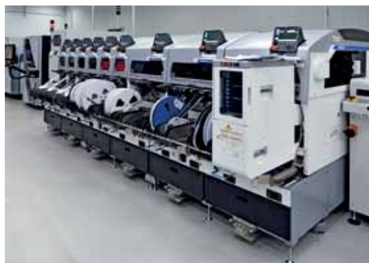
Трафаретный принтер DEK Horizon 031X и установка АОИ нанесения пасты Viscom S3088 SPI (слева), модульные установщики Fuji NXT II (справа)
