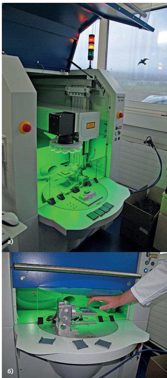
Рис.4. Машина лазерной активации Microline 3D компании LPKF (а), установка заготовки в держатель на поворотном столике (б)
