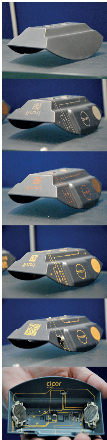
Рис.5. Последовательность технологических операций 3D-MID: а) заготовка после отливки; б) лазерная активация токопроводящего рисунка; в) осаждение меди; г) осаждение финишного покрытия; д, е) двусторонний монтаж компонентов
