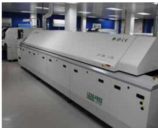
Печь оплавления JT RS-800
