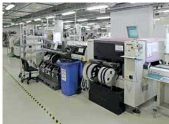
Установщики компонентов Assembleon. На заднем плане – система AX-301, на переднем – Topaz Xi 11
