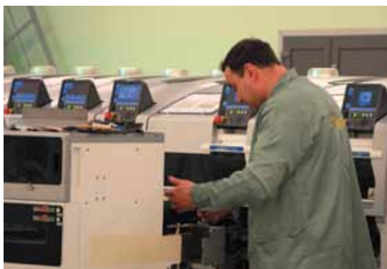
Рис.10. Специалисты Остека проводят регулярное техническое обслуживание линии поверхностного монтажа
