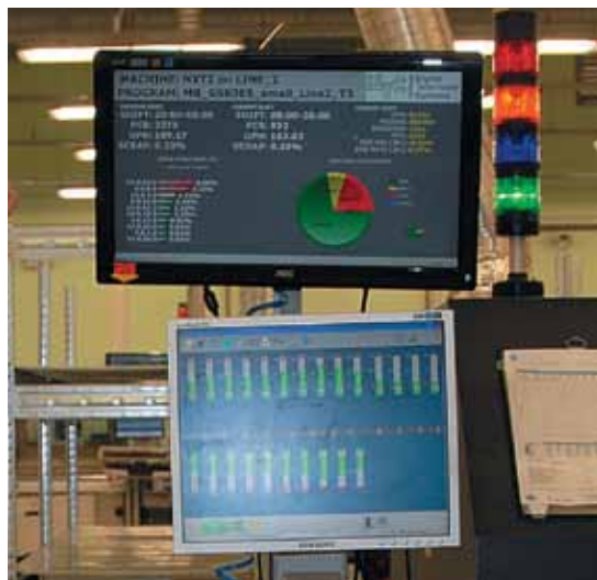
Рис.8. Система контроля за сбросом компонентов при установке
