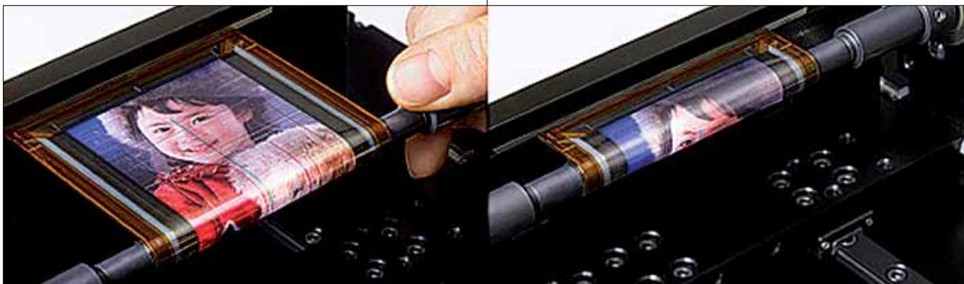
**Рис.7. Гибкая панель компании Sony**
