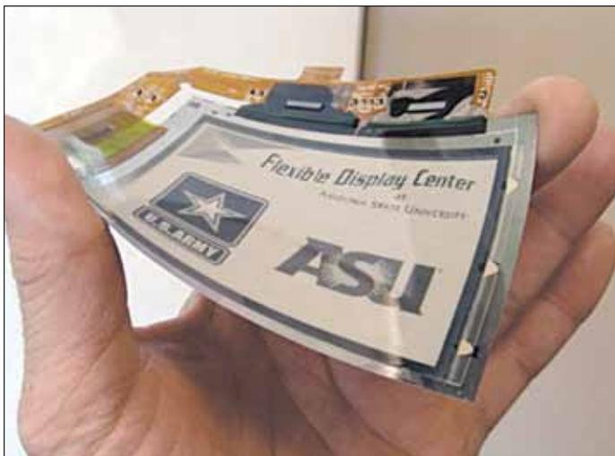
**Рис.6. Гибкий дисплей с сенсорным экраном Центра гибких дисплеев**
