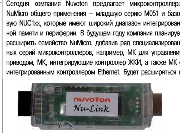
**Рис.5. Программатор/отладчик Nu-Link**
