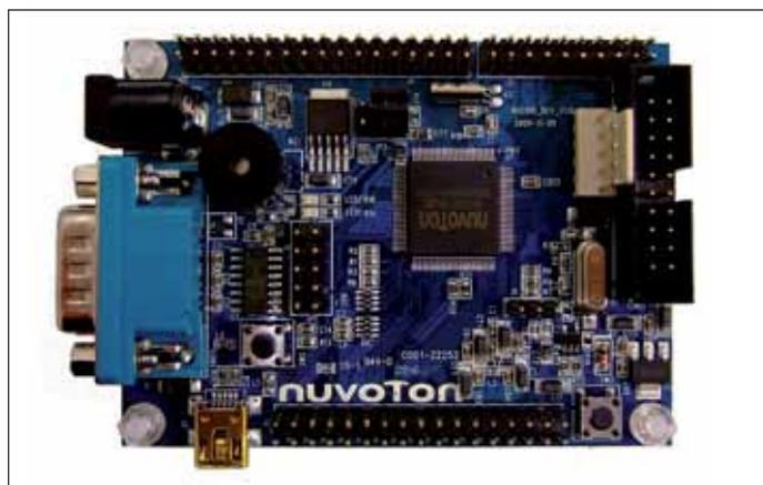
**Рис.6. Плата Nu-EVB-NUC140, входящая в состав комплекта NuMicro-SDK**
