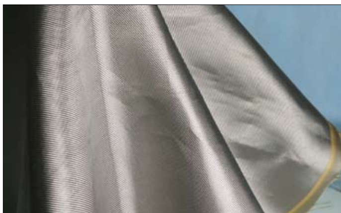
Рис. 1. Вид пленки аморфного гидрогенизированного углерода с ферромагнитными наночастицами на гибкой подложке из арамидной ткани (кевлар)
