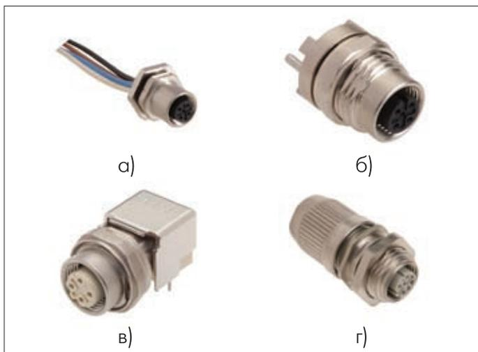
**Рис.8. Соединители M12: а) блочная часть с подсоединенными проводами; б) блочная часть под пайку в плату (вертикально); в) блочная часть под пайку в плату (горизонтально); г) кабельная часть**
