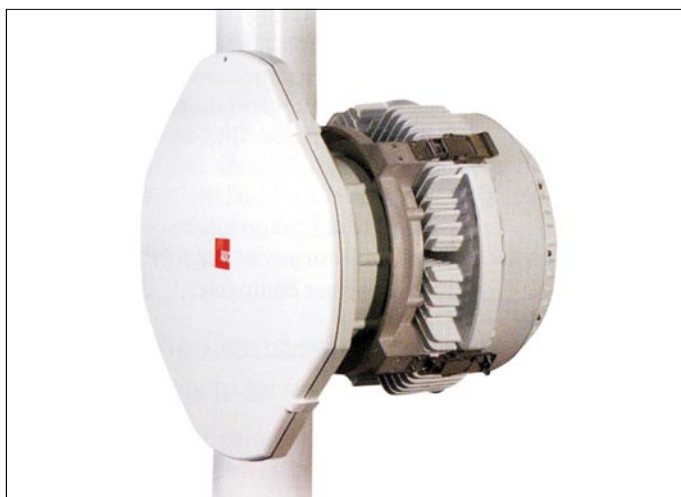
Рис.6. Радиосистема MMW 125 Е-диапазона компании ADC Telecommunications
