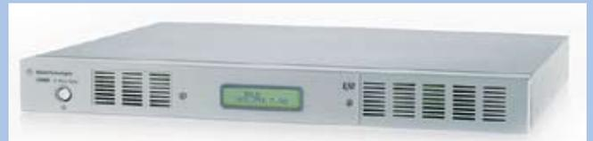
сигнала перед оцифровкой. Дигитайзеры способны выполнять целый ряд "осциллографических" измерений, например, измерять минимальное и максимальное значение напряжения, размах напряжения, частоту и длительность переднего/заднего перепада выбранного фрагмента сигнала. Встроенные измерительные функции позволяют экономить время последующей обработки и сократить объем передаваемых и хранимых данных.
