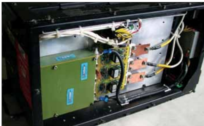
Рис. 10. Преобразователь собственных нужд с использованием заказного конденсатора
