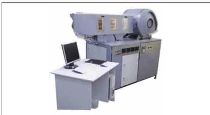
**Рис.4. Установка V3-901M для нанесения париленового покрытия**
