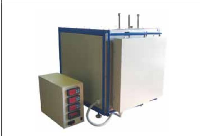
**Рис.5. Печь "Радуга-10.5МА" для оплавления припойных паст, сушки и задубливания материалов в бескислородной среде**
