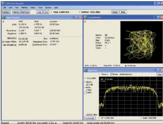
Рис.8. Синхронный мультидоменный анализ СШП-сигнала с модуляцией QAM16 и скоростью потока 312,5 Мсим/с. Сигнал занимает полосу примерно 500 МГц
