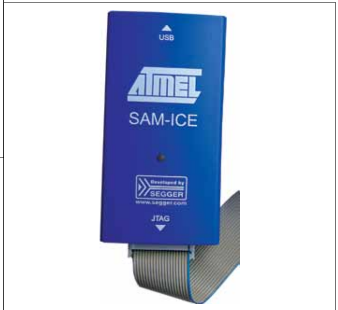
Рис.6. Внутрисхемный эмулятор AT91SAM-ICE
