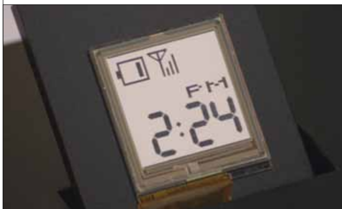
Рис. 1. Дисплей с памятью LS013B4DN02
