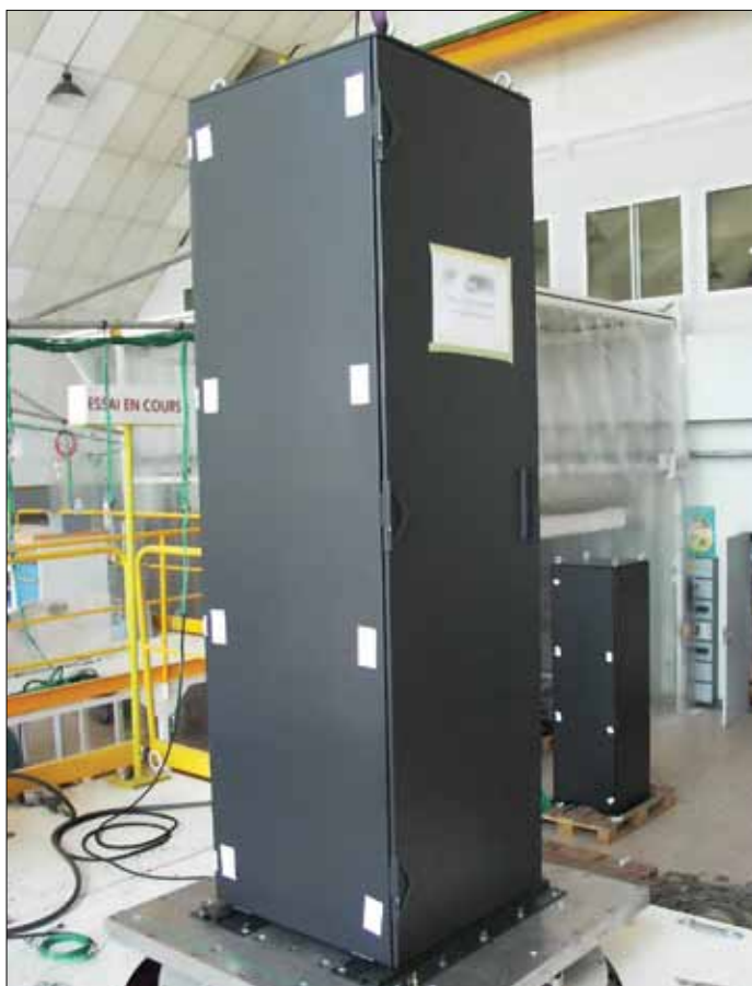
Рис.3. Лабораторные испытания на ударо- и вибропрочность
