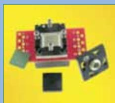
Компания Ironwood Electronics, производитель панелек, адаптеров, преобразователей для различных корпусов микросхем, выпустила адаптер для тестирования СВЧ-микросхем SBT-BGA-7003. В тестовом адаптере используются штампованные пружинные контакты,
