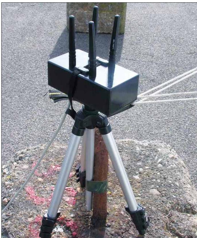
Рис.7. 4-антенная MIMO-система связи с БПЛА
