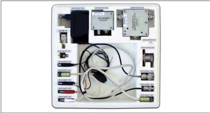
Рис.5. Внешний вид преобразователя напряжения В9-26 в укладочном ящике. Вместе с блоком преобразования В9-26/10 поставляется модуль сетевого АС-DC адаптера, промежуточный модуль питания, а также контрольный детектор, используемый при поверке
