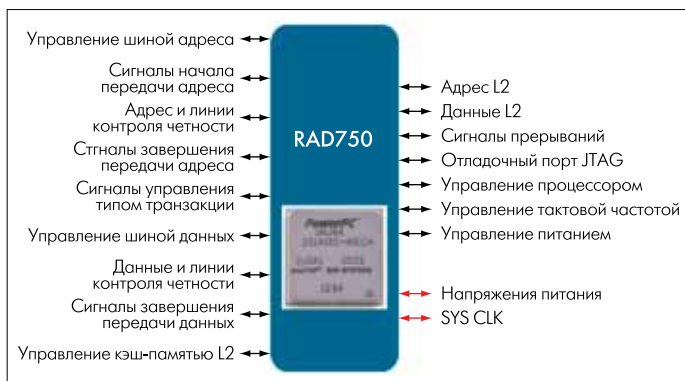
Рис. 1. Основные сигналы микропроцессора RAD750
