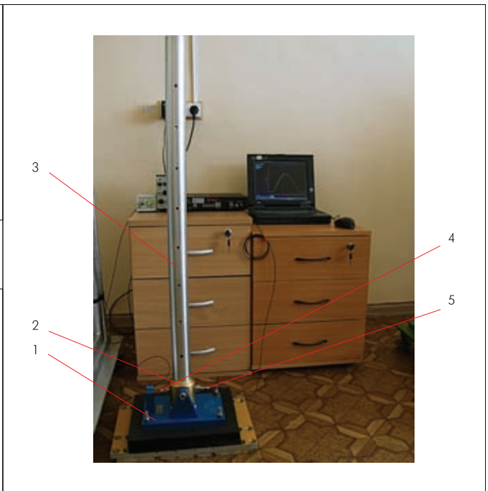
Рис.6. Импульсный калибратор 913B02 фирмы РСВ: 1 – станция, 2 – поршень, 3 – направляющая труба, 4 – эталонный датчик, 5 – калибруемый датчик
