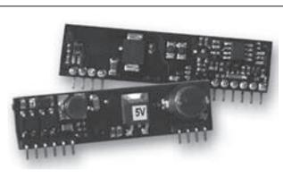
Модули серии, так же как и устройства серии Ag9000, включают два встроенных мостовых выпрямителя. Выходное напряжение модулей серии составляет 36–60 В. Как и модули серии Ag9000, они требуют применения одного внешнего дешевого развязывающего конденсатора с минимальной емкостью 470 мкФ. Для регулировки уровня выходного напряжения также используется вывод ADJ. Значения номинального выходного напряжения могут изменяться в диапазоне 2,4–13 В.
