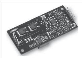
Компания Silver Telecom выпустила модули Ag5000, удовлетворяющие требованиям стандарта IEEE802.3at и обеспечивающие выходную мощность до 30 Вт. Модули предназначены для таких приложений, как точки доступа WiMax, IP-телефония, камеры и компьютеры с дистанционным управлением. Задача обеспечения питания в соответствии с требованиями PoE+ решена в модуле с помощью совместного динамического ис-
