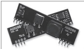
У модулей серии нет гальванической развязки входа и выхода. Они имеют высокий КПД. Модули требуют применения четырех внешних компонентов: двух мостовых выпрямителей на входе, резистора регулировки и конденсатора с минимальной емкостью 470 мкФ на выходе. Помимо трех значений номинального выходного напряжения, можно установить любое значение в диапазоне 2,5–14 В.
