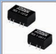
Преобразователи TES-1 работают при входных напряжениях 5, 12 или 24 В (±10%) и обеспечивают на выходе стандартные напряжения 5, 12, 15, ±5, ±12, ±15 В. Максимальная выходная мощность 1 Вт. Новые модели имеют более высокую прочность изоляции по сравнению с серией TSM – 1500 В. Немаловажной может оказаться и такая характеристика, как нагрузочная способность по емкости. У новой серии этот параметр составляет 33 мкФ, что выше, чем у преобразователей серии TSM.
