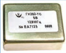
ОАО "МОРИОН" (С-Петербург) разработало новые типы кварцевых термокомпенсированных генераторов – ГК202-ТК и ГК203-ТК. Генераторы обеспечивают уровни стабильности, характерные для термостатированных генераторов (долговременная нестабильность частоты – до  $\pm 1 \times 10^{-7}$ /год, температурная нестабильность частоты – до  $\pm 5 \times 10^{-8}$ ), сохраняя при этом такие достоинства термокомпенсированных гене-
