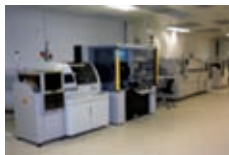
Рис.2. Автоматизированная линия сборки микросхем фирмы Palomar (США)
