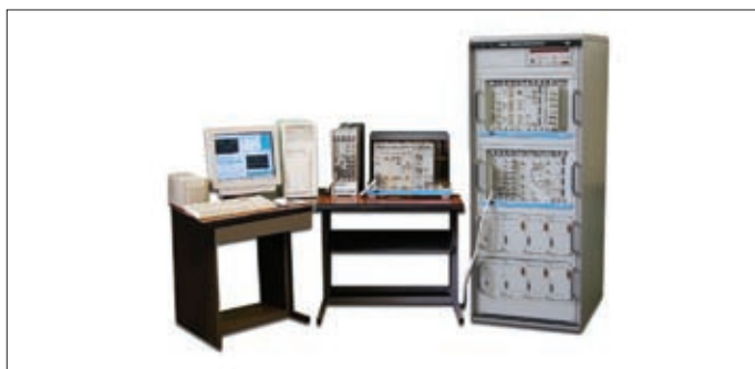
Рис. 12. Магистрально-модульная контрольно-измерительная аппаратура на основе шины VXI
