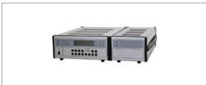
Рис.3. Стандарт частоты рубидиевый Ч1-83
