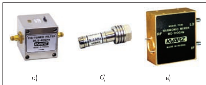
Рис.11. СВЧ-устройства: а) – полосно-пропускающий фильтр с ЖИГ-перестройкой, б) – нагрузка согласованная фиксированная, в) – гармонический смеситель
