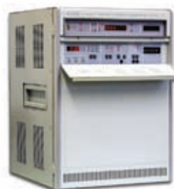
Рис. 1. Активный водородный стандарт частоты Ч1-75А
