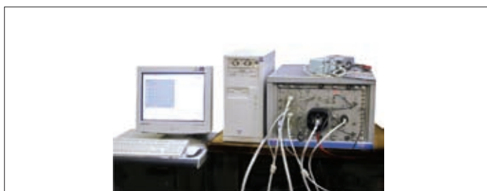
Рис. 13. Автоматизированная система контроля параметров импульсных альтиметров (на базе шины VXI)
