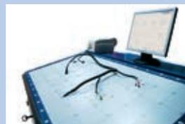
Стенд выполняет четырехпроводные измерения, проверку на КЗ/обрывы, измерение сопротивления цепи, локализацию места дефекта, обеспечивает контроль сопротивления изоляции, наличия фиксатора разъема, герметичности разъемов жгута. В качестве опции возможно тестирование компонентов.
