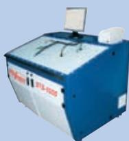
В мае 2008 года ассортимент производимого ООО "Совтест АТЕ" оборудования пополнился еще одной новой разработкой – стендом для проверки автомобильных жгутов модели STC-1000. Стенд предназначен для проверки электрических параметров и геометрии автомобильных жгутов, хотя может использоваться и при тестировании проводки в самолетах, вертолетах, подводных лодках и электровозах, а также при тестировании интерфейсных кабелей и кабелей питания медицинской аппаратуры.
