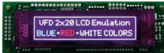
**Рис.4. Модуль NORITAKE GU128X29EC-7806A. При фотографировании использовался модуль, снабженный розовым светофильтром**
